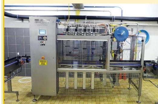
Mit der neuen Anlage wird die Abfüllkapazität etwas mehr als verdoppelt. Bei Bedarf kann ein Tank sogar innerhalb eines Tages komplett geleert werden. Zudem erfährt der Abfüllprozess eine Veränderung. Das Leergut wird vor der Befüllung mit CO2 ausgespült, das ermöglicht eine sauerstofffreie Abfüllung. Dieser Vorgang wirkt sich positiv auf die Bierqualität aus. Die Farbe und der Geschmack bleiben konstanter, ebenso wird die übermässige Bildung von Kohlensäure vermindert.
